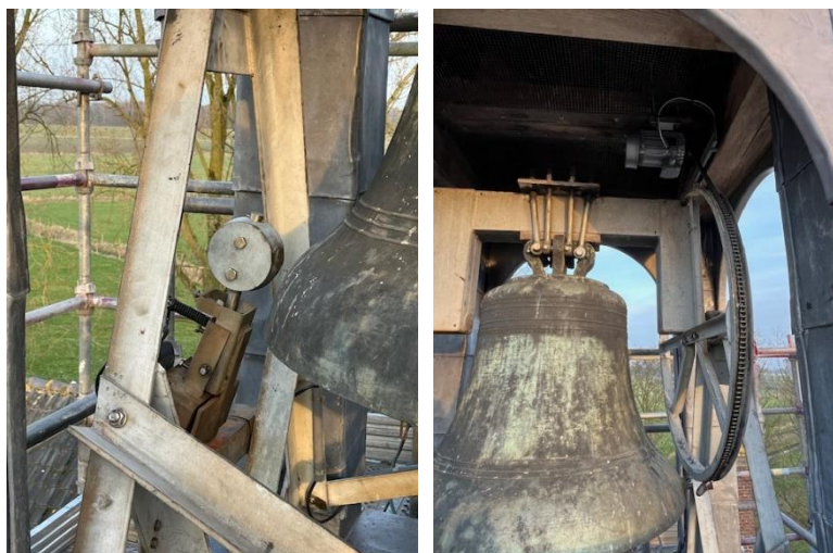
Linkse de "hamer" die de (halve) uren slaat en rechts de aandrijving van de klok
